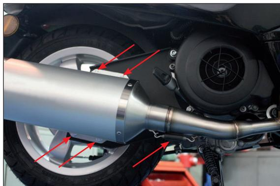
Innestare il terminale, serrare gli attacchi al telaio ed ancorare la molla. Serrare definitivamente il collettore al cilindro
