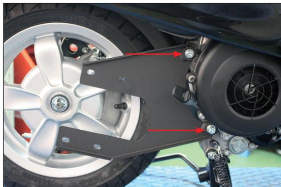
Avvitare al motore la staffa di sostegno terminale
