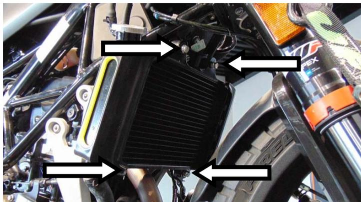
**IT** · Svitare le viti superiori/inferiori (2+2) di fissaggio radiatore e spostarlo verso l'anteriore
