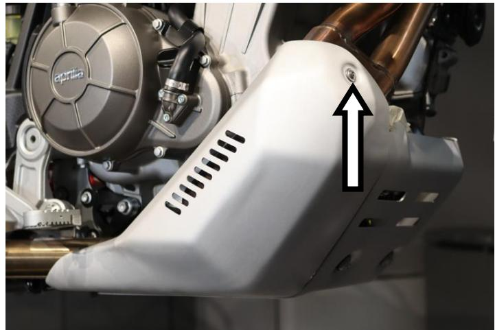
**IT** · Svitare la vite indicata e rimuovere la protezione laterale DX
