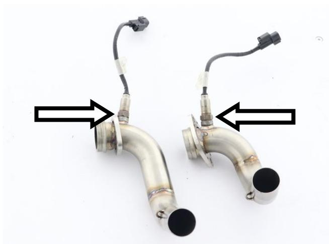
**IT** · Avvitare le sonde lambda nei collettori Arrow senza invertirle posizionando le flange come mostrato in foto
