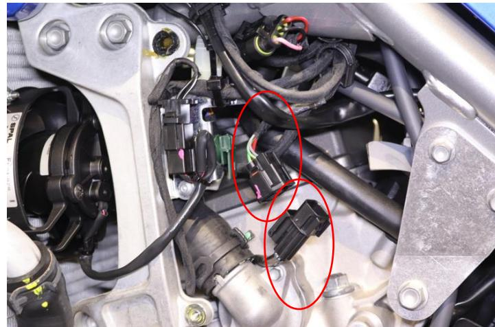
**IT** · Sfilare il connettore della sonda lambda SX dalla propria sede, disconnettere il cablaggio e liberare il cavo per poterlo rimuovere assieme ai collettori
