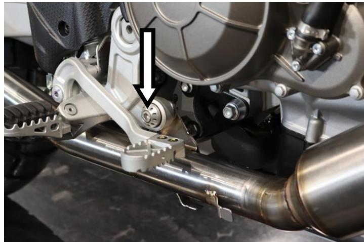
**IT** · Innestare il raccordo e serrare senza stringere completamente l'attacco al telaio
