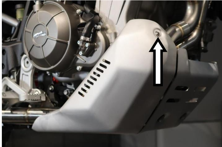
IT · rimontare la protezione laterale DX
