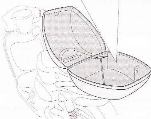
**I** Fissare il bauletto al portapacchi tramite le viti 2 TBEI M6X35 e i dadi 3 autobloccanti M6.
